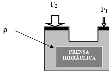
*Nota bene:*  $\rho$  es la densidad del fluido al interior de la prensa hidráulica.
